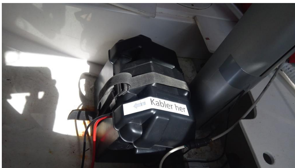
Figur 2: Batterikassen er normalt lukket med låg og fastgjort med en strop.
