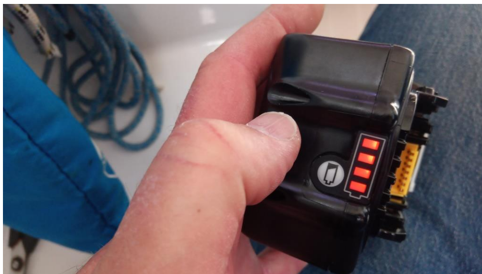
Figur 14: Undersøg batteriets ladestand ved at trykke på den hvide tast med batterisymbolet.
