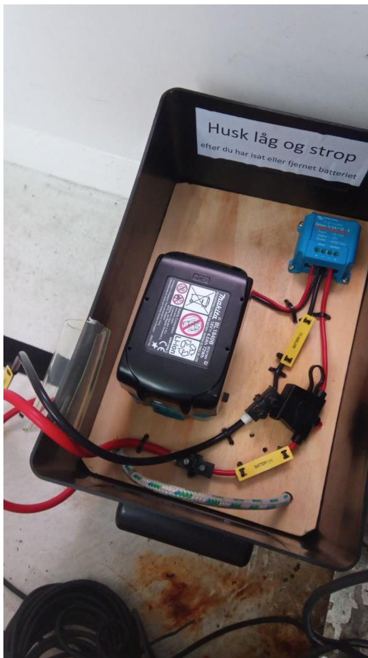
Figur 5: Batterikasse med isat batteri
