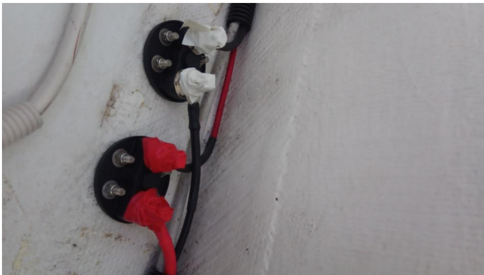
Figur 8: Batterikablets forbindelse til hovedafbryderne skal være tapet op som vist her eller på anden måde beskyttet mod kortslutning.
